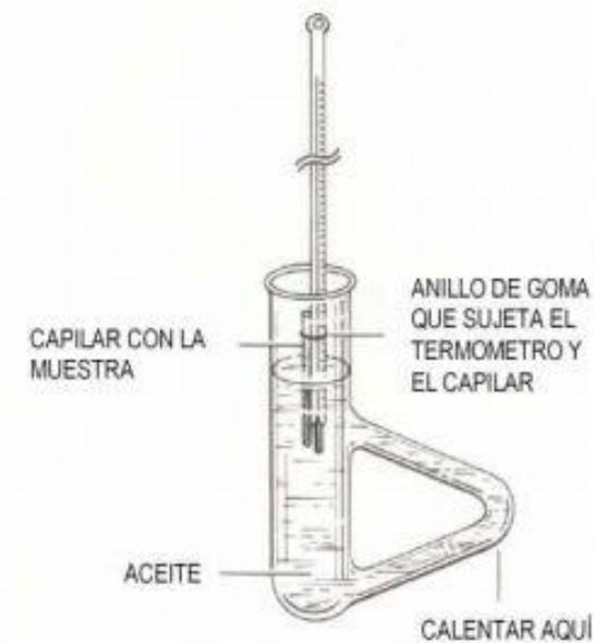
Tubo Thiele para determinar punto de ebullición, fuente TP Laboratorio química
